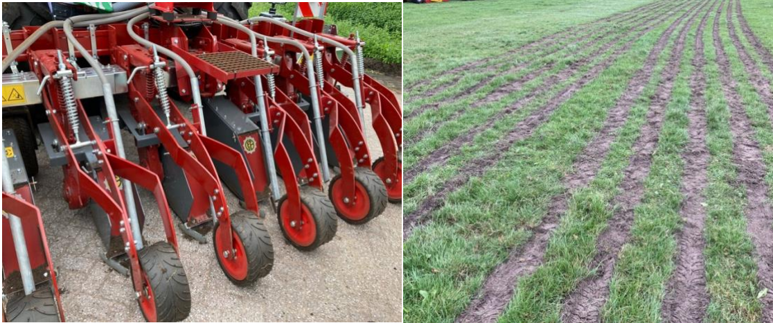
Figuur 4.3: Links een strokenfrees, rechts het resultaat van doorzaaien met een strokenfrees van een bestaand graslandperceel van een melkveehouder (foto rechts: J. Lommen).
