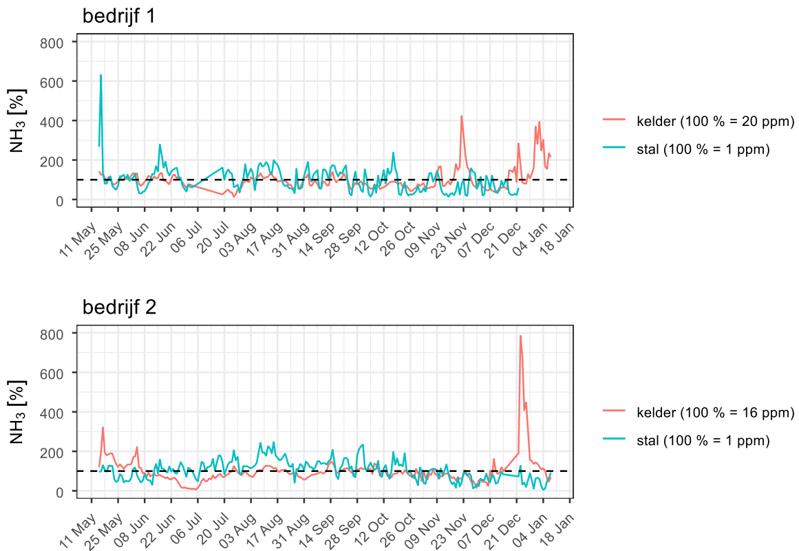
Figuur 11: Relatieve ammoniakconcentraties in de kelder (rode lijn) en stal (groene lijn).
